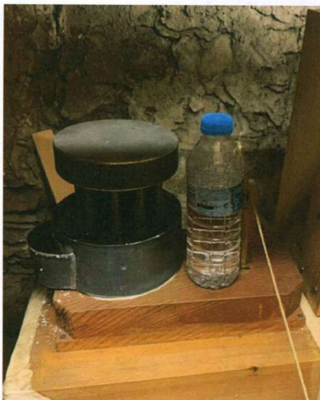
Le rossignol dans sa position actuelle et le système de mise en route qui s'use dans l'angle et a déjà cassé
