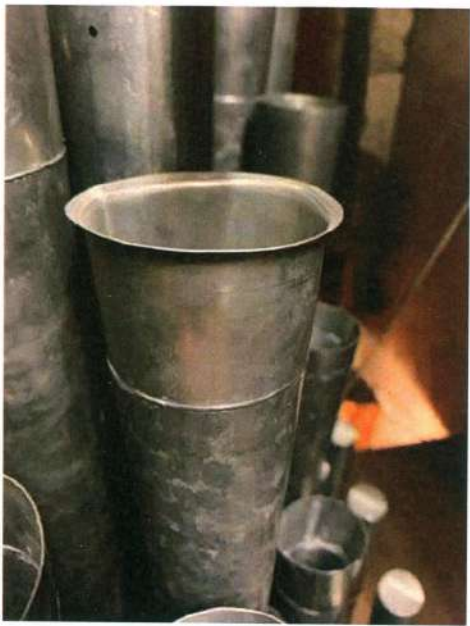
Un pavillon d'anche anormalement égueulé
