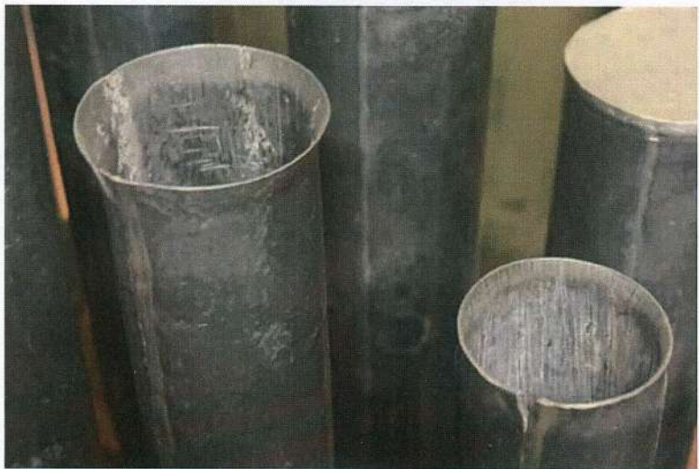
Les déchirures nombreuses des hauts de tuyaux (coup de cisaille ou d'accordoir)
