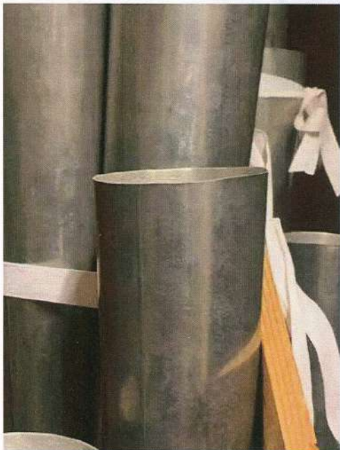
Les déchirures nombreuses des hauts de tuyaux (coup de cisaille ou d'accordoir)
