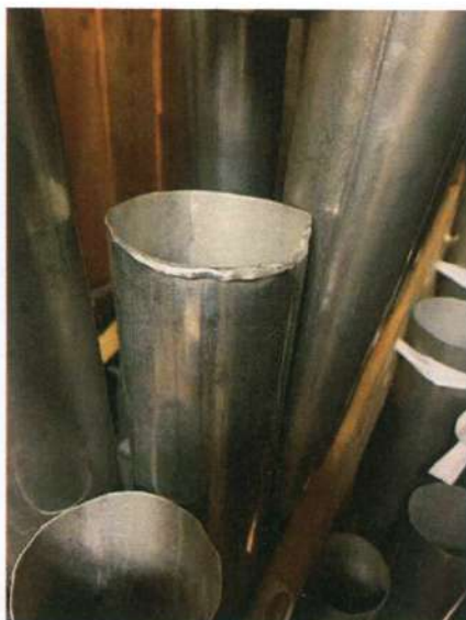
Haut de pavillon d'anches abîmé
